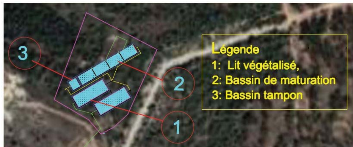
FIGURE 8. VUE D'ENSEMBLE DES OUVRAGES DE POST-TRAITEMENT
