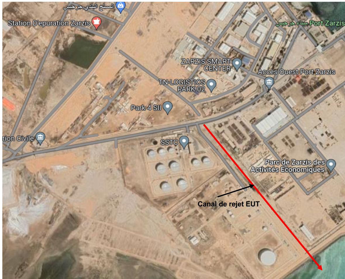
Figure 9 : STEP Zarzis et tracé de la canalisation de rejet en mer sur image Google Earth (septembre, 2023)
