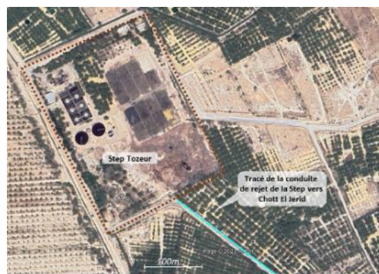
Figure 6 : Vue rapprochée de la Step de Tozeur montrant le point de départ de la conduite de rejet vers Chott El Jerid (Source : Google Earth)
