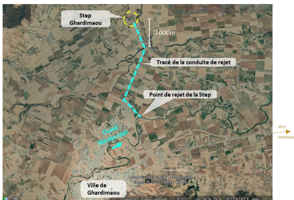
Figure 20: Rejet des EE de la Step de Ghardimaou (Source de l'image de fond: Google Earth)
